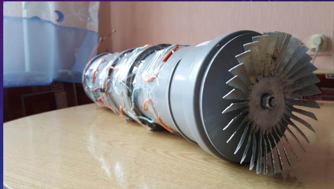
ОПЫТНЫЙ ОБРАЗЕЦ – ЭТО РАБОЧИЙ ВЕТРОГЕНЕРАТОР (АВТОВЕТРОТУРБИНА) НА НЕОДИМОВЫХ МАГНИТАХ.
